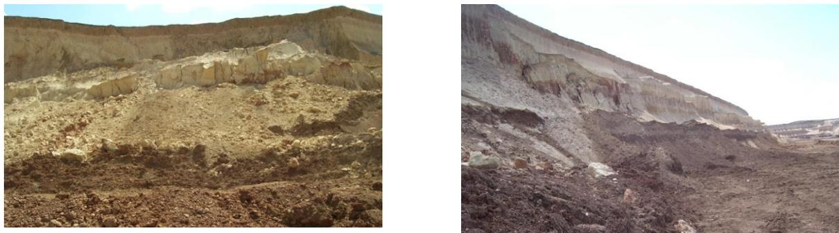
Рис. 13.6. Обрушения пород вскрыши на передовом уступе
